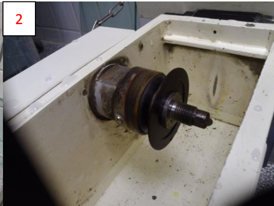
裝上左墊片(半徑較大面朝刀片)
