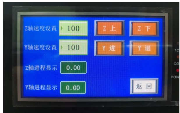
9. 調整 Y、Z 軸，取適當鑽石線與樣品間之位置，完成後按返回。
