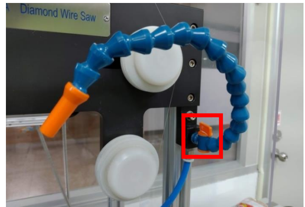
9. 調整 Y、Z 軸，取適當鑽石線與樣品間之位置，完成後按返回。
