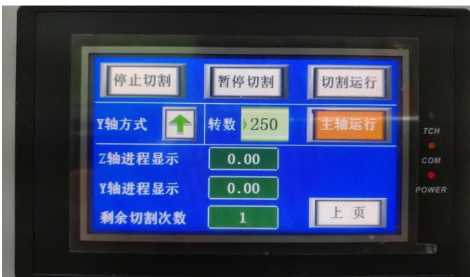
12. 先點選主軸運行，再點選切割運行。
