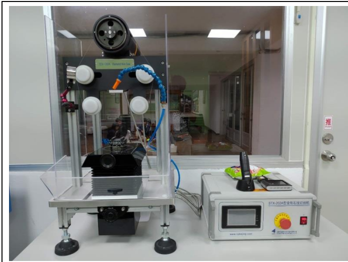
1. 小型鑽石線切割機(機具(左)加主機(右))
