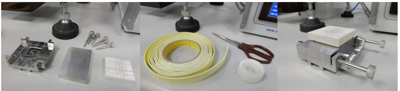
5. 組裝方解石載台(十字載台、鐵塊、方解石塊、螺絲、雙面膠布、3M 透明膠帶)
